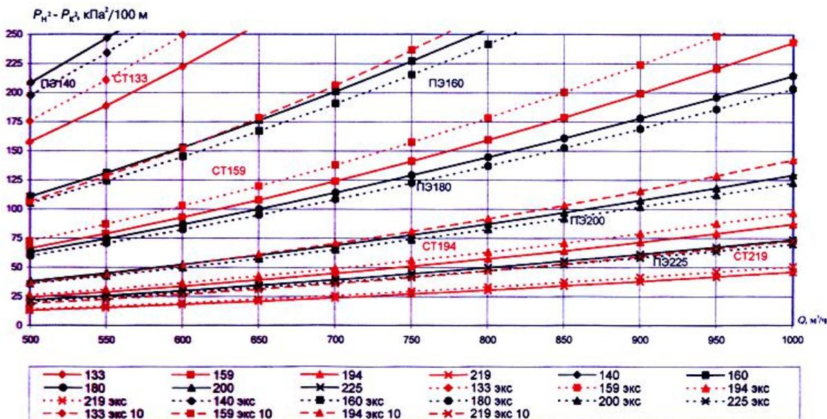
Удельные потери давления для стальных и полиэтиленовых труб (новых и бывших в эксплуатации) высокого давления ( $Q$  0-200 м/ч,  $\rho=0,73$  кг/м,  $\nu=1,4 \times 10_{(-6)}$  кв.м/с)
