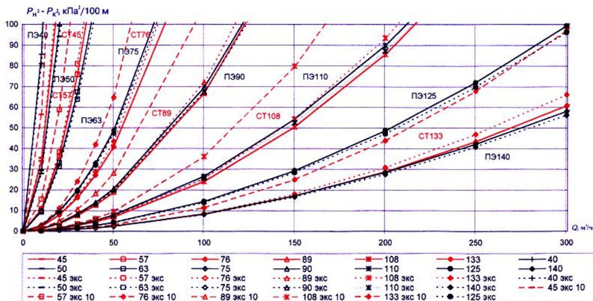
Удельные потери давления для стальных и полиэтиленовых труб (новых и бывших в эксплуатации) высокого давления ( $Q$  2000-10000 м<sup>3</sup>/ч,  $\rho=0,73$  кг/м<sup>3</sup>,  $\nu=1,4 \times 10^{-6}$  кв.м/с)
