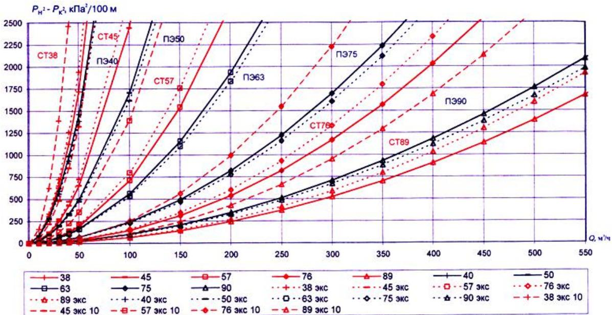
Удельные потери давления для стальных и полиэтиленовых труб (новых и бывших в эксплуатации) высокого давления ( $Q$  500-1000 м/ч,  $\rho=0,73$  кг/м,  $\nu=1,4 \times 10_{(-6)}$  кв.м/с)
