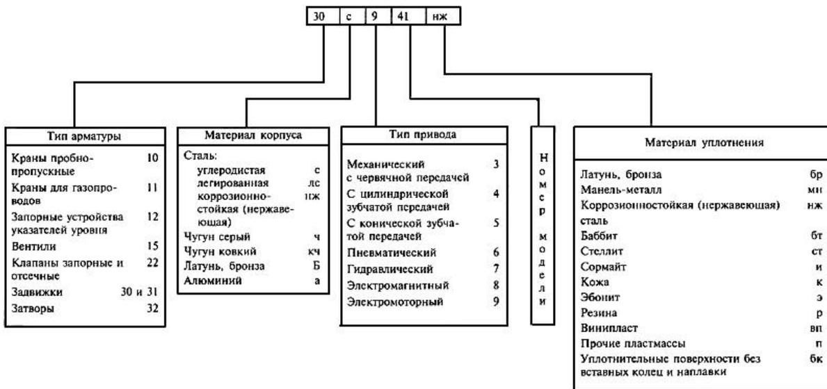
Для арматуры с электроприводом во взрывозащитном исполнении в конце условного обозначения добавляется буква Б, например: 30ч906брБ.
