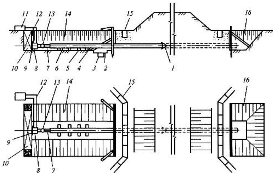
1 - конусный наконечник; 2 - прямок для сварки звеньев футляра в потолочном положении; 3 - прямок для стока грунтовых вод; 4 - труба-футляр; 5, 6 - направляющая рама; 7 - набор нажимных патрубков; 8 - гидродомкрат; 9 - опорный башмак; 10 - упорная стенка; 11 - насосная станция; 12 - трубки высокого давления; 13 - торцовая нажимная заглушка; 14 - рабочий котлован; 15 - водоотводной лоток; 16 - приемный котлован
