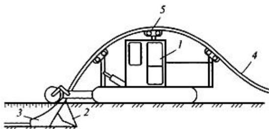
1 - гусеничный тягач; 2 - режущий нож; 3 - щелесасыпщик; 4 - трубая плеть; 5 - роликоопоры
