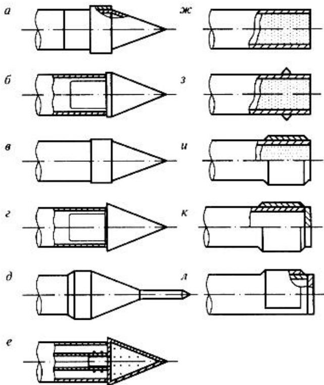
*а, б, в* - конусные наконечники; *г* - конусный наконечник с эксцентриситетом; *д* - конусный наконечник с направляющей иглой; *е* - конусный наконечник с отверстиями для увлажнения грунта; *ж* - открытый конец футляра без наконечника; *з* - открытый конец кожуха с кольцом из круглой стали; *и* - кольцевой нож с наружным скосом режущих кромок; *к* - кольцевой нож с наружным скосом режущих кромок и приварной заглушкой; *л* - нож серпообразного сечения с приварной заглушкой
