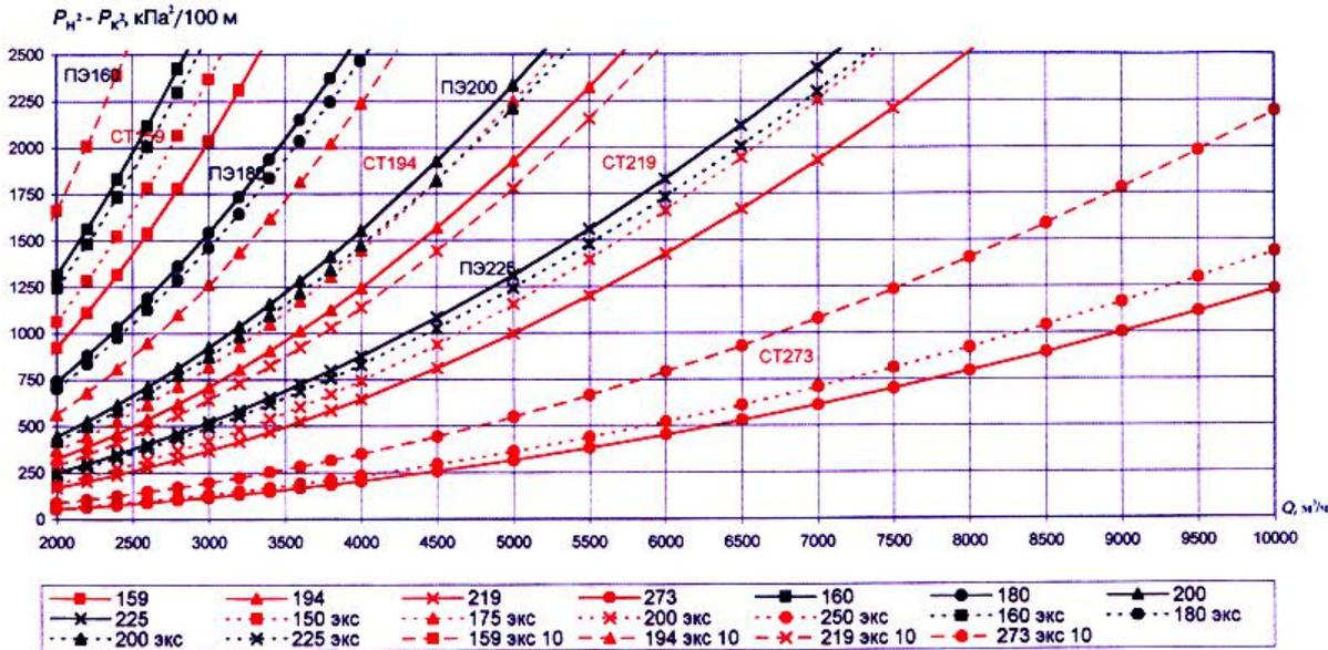
Удельные потери давления для стальных и полиэтиленовых труб (новых и бывших в эксплуатации) высокого давления ( $Q$  500-2500 м<sup>3</sup>/ч,  $\rho=0,73$  кг/м<sup>3</sup>,  $\nu=1,4 \times 10^{-6}$  м<sup>2</sup>/с)
