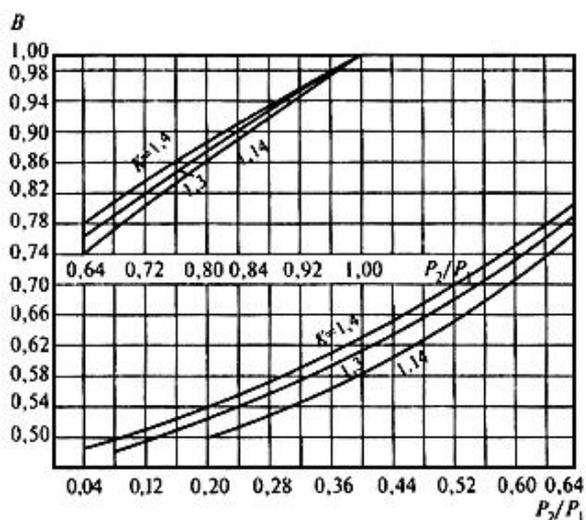
Рисунок 6 - Зависимость коэффициента  $B$  от  $P_2 / P_1$ .
