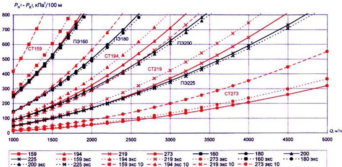
Удельные потери давления для стальных и полиэтиленовых труб (новых и бывших в эксплуатации) низкого давления ( $Q$  250-1250 м<sup>3</sup>/ч,  $\rho=0,73$  кг/м<sup>3</sup>,  $\nu=1,4 \times 10^{-6}$  м<sup>2</sup>/с)
