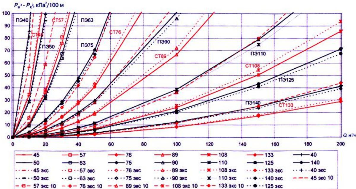
Удельные потери давления для стальных и полиэтиленовых труб (новых и бывших в эксплуатации) высокого давления ( $Q$  0-500 м<sup>3</sup>/ч,  $\rho=0,73$  кг/м<sup>3</sup>,  $\nu=1,4 \times 10^{-6}$  кв.м/с)
