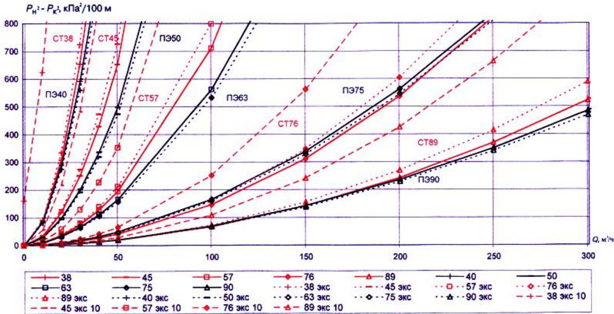
Удельные потери давления для стальных и полиэтиленовых труб (новых и бывших в эксплуатации) среднего давления ( $Q$  250-1000 м<sup>3</sup>/ч,  $\rho=0,73$  кг/м<sup>3</sup>,  $\nu=1,4 \times 10^{-6}$  кв.м/с)
