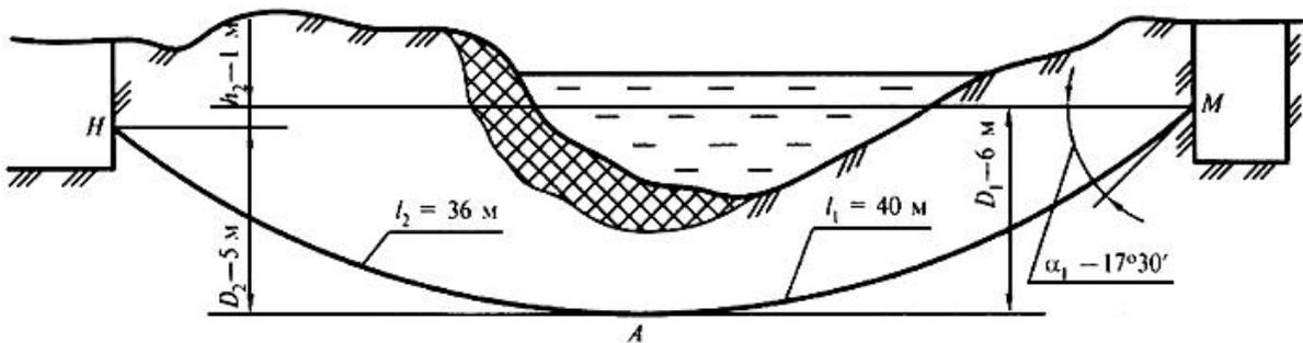
Рисунок Л.4 - Расчетные параметры пилотной скважины
