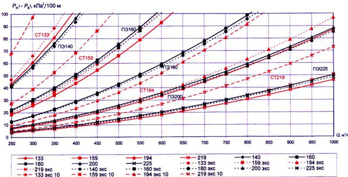
Удельные потери давления для стальных и полиэтиленовых труб (новых и бывших в эксплуатации) среднего давления ( $Q$  0-150 м<sup>3</sup>/ч,  $\rho=0,73$  кг/м<sup>3</sup>,  $\nu=1,4 \times 10^{-6}$  кв.м/с)
