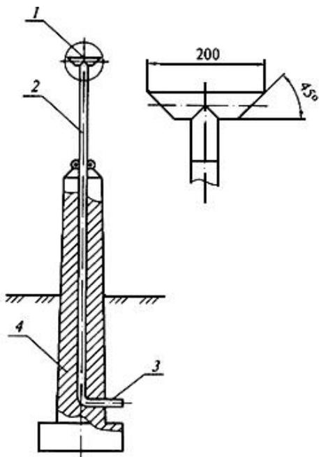
1 - оголовник; 2 - вытяжная труба; 3 - отводная труба; 4 - фундамент
