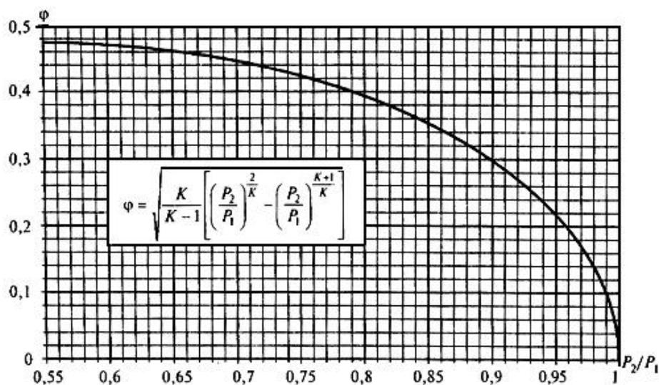
$K$  - показатель адиабаты газа при давлении 750 мм вод.ст. и температуре 0 °С,  $C_p$  - теплоемкость при постоянном давлении, ккал/(м<sup>3</sup>·°С),  $C_v$  - теплоемкость при постоянном объеме, ккал/(м<sup>3</sup>·°С)
