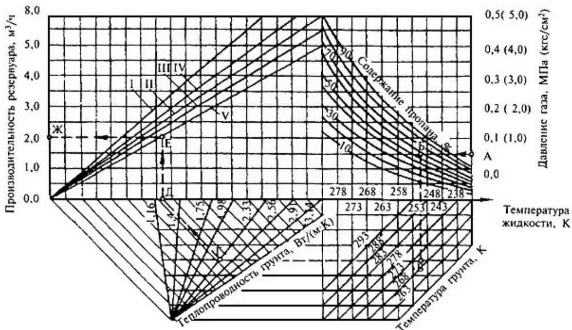
I - резервуар 5 м<sup>3</sup>, заполнение 85%; II - резервуар 5 м<sup>3</sup>, заполнение 50%; III - резервуар 5 м<sup>3</sup>, заполнение 35% и резервуар 2,5 м<sup>3</sup>, заполнение 50%; IV - резервуар 2,5 м<sup>3</sup>, заполнение 85%; V - резервуар 2,5 м<sup>3</sup>, заполнение 35%
