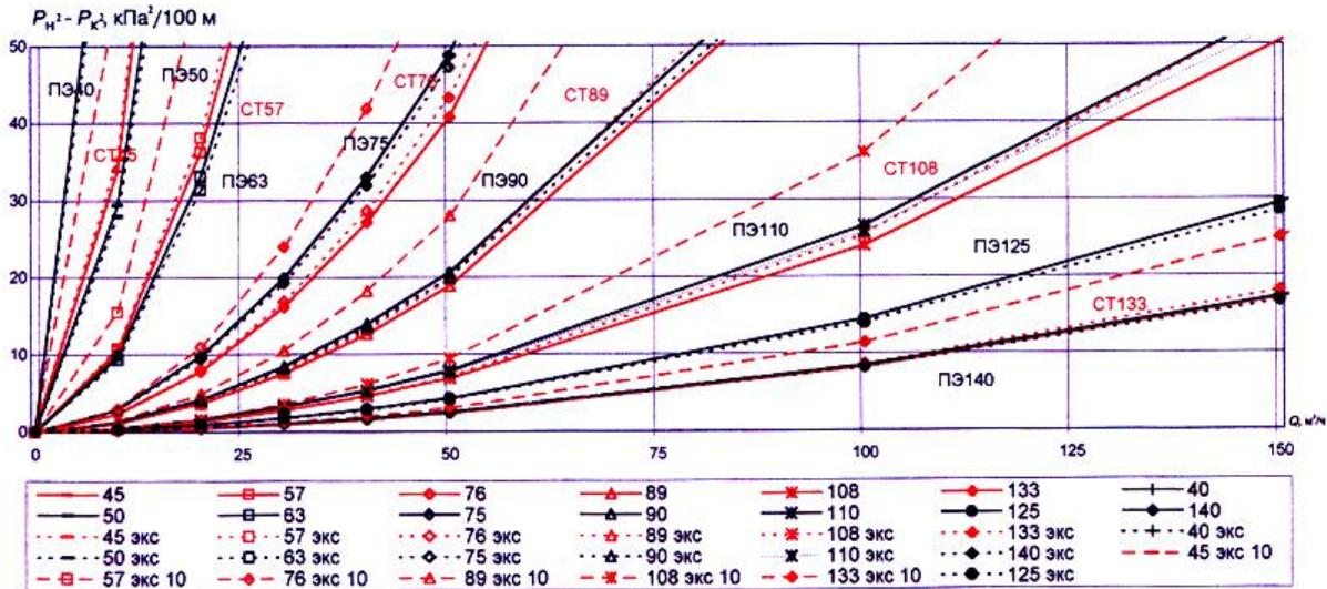
Удельные потери давления для стальных и полиэтиленовых труб (новых и бывших в эксплуатации) среднего давления ( $Q$  0-300 м<sup>3</sup>/ч,  $\rho=0,73$  кг/м<sup>3</sup>,  $\nu=1,4 \times 10^{-6}$  кв.м/с)
