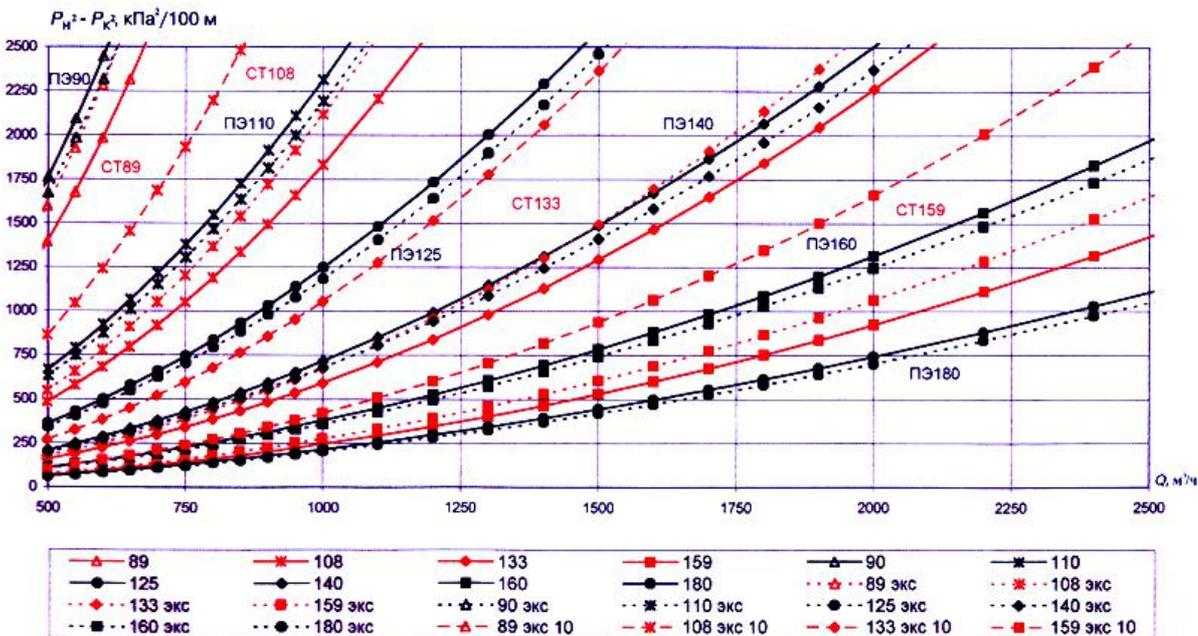
Удельные потери давления для стальных и полиэтиленовых труб (новых и бывших в эксплуатации) высокого давления ( $Q$  0-550 м<sup>3</sup>/ч,  $\rho=0,73$  кг/м<sup>3</sup>,  $\nu=1,4 \times 10^{-6}$  м<sup>2</sup>/с)
