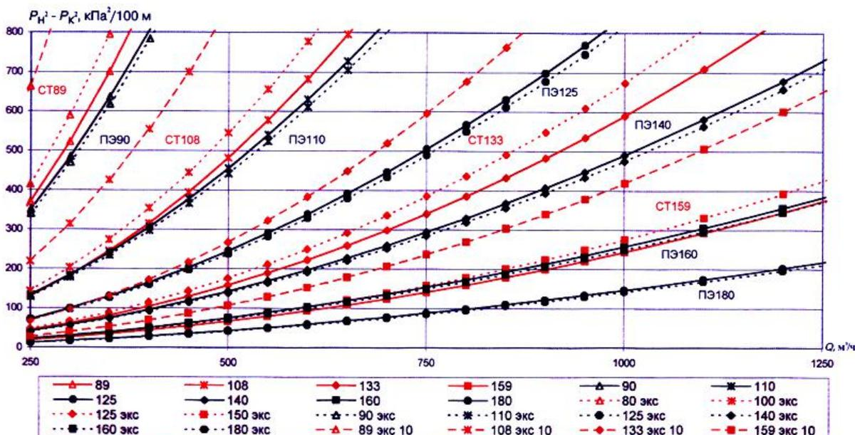
Удельные потери давления для стальных и полиэтиленовых труб (новых и бывших в эксплуатации) среднего давления ( $Q$  0-300 м<sup>3</sup>/ч,  $\rho=0,73$  кг/м<sup>3</sup>,  $\nu=1,4 \times 10^{-6}$  м<sup>2</sup>/с)
